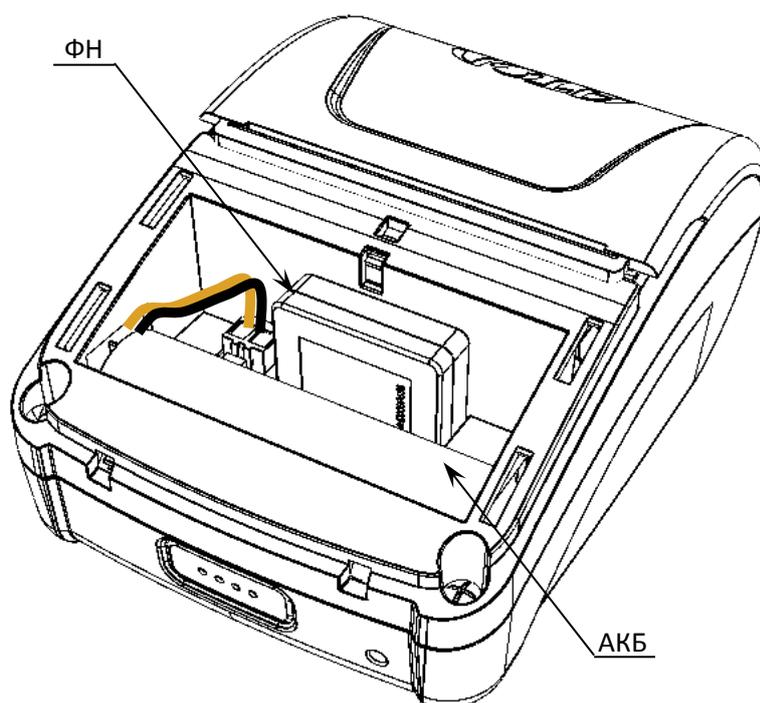
Рисунок 13. Место расположения ФН и АКБ в корпусе ККТ, для версии ККТ с АКБ
