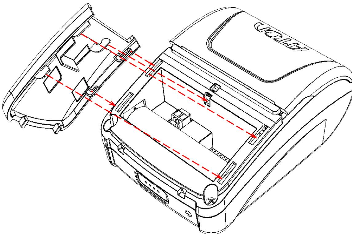
Рисунок 6. Установка крышки отсека для АКБ и ФН
